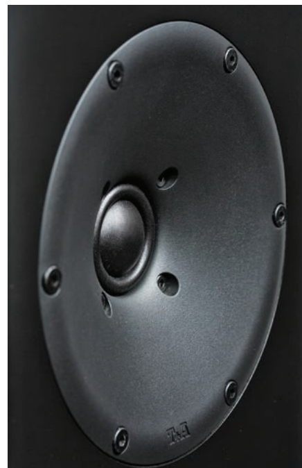
Duże wyprofilowanie przed (tekstylną) kopułką wysokotonową zmienia charakterystyki kierunkowe tak, aby zbliżyły się one do charakterystyki głośnika średniotonowego w zakresie częstotliwości podziału.
