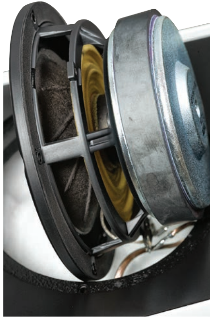
Głośnik średniotonowy, oglądany z każdej strony, bardzo przypomina 15-cm Revelatora Scan-Speaka, ale można też znaleźć wiele szczegółów, „którymi różnią się te dwa obrazki”.
