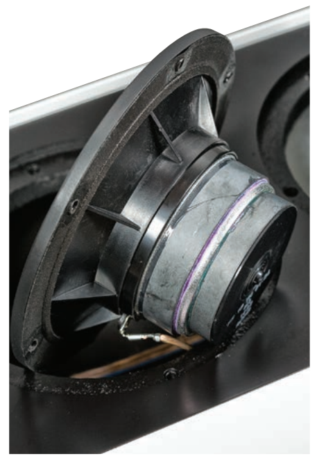
Puszkę, w której wytłumiane jest ciśnienie od tylnej strony kopułki, współtworzy dodatkowy, mniejszy pierścień ferrytowy.
