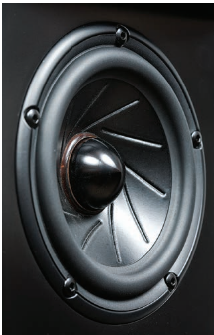
Jeden z dwóch 15-cm średniotonowych; przetłoczenia membrany rozpraszają jej rezonanse – to pomysł skądinąd znany.
